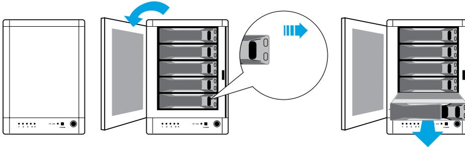
3. Установите жесткий диск в салазки и закрепите винтами, прилагающимися в комплекте поставки
